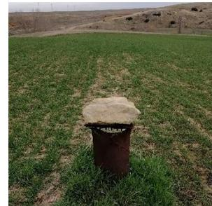
*Figura 5: Sondeo con embocadura de hierro en una tierra de labor. En la actualidad la boca está tapada para evitar riesgos de caídas.*
