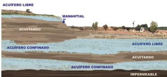
Figura 20. Tipos de acuíferos detríticos según sus características hidrodinámicas. Fuente: Sistema Integrado de Información del Agua (SIA).
