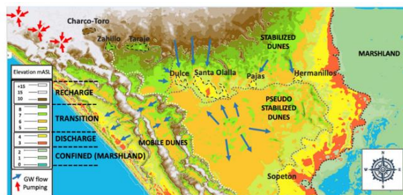
Figura 8: Croquis del funcionamiento hidrogeológico del sistema Dulce-Santa Olalla-Pajas (Fernández-Ayuso et al., 2023; Rodríguez-Rodríguez et al., 2021)
