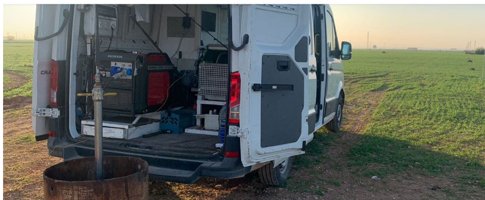
Figura 4. Equipo de registro videográfico y testificación geofísica emplazado en un sondeo de captación de aguas subterráneas.
