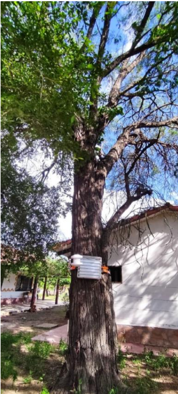
Fotografía 3. Sensores experimentales instalados, que permiten monitorear el flujo de savia, humedades y albedo.
