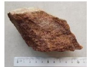
Arenisca fracturada con alto contenido de óxidos de hierro y minerales arcillosos.
