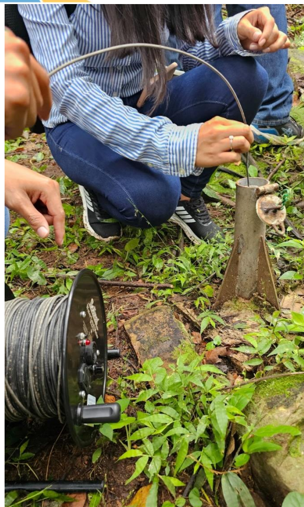
Fotografía 2. Imagen de un piezómetro instalado en la zona baja, que permite monitorear las variaciones del nivel freático.
