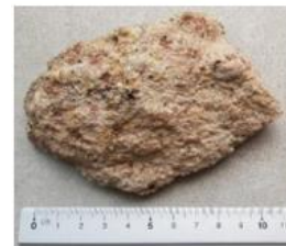
Arenisca suelta y fracturada con alto contenido de granos de cuarzo.
