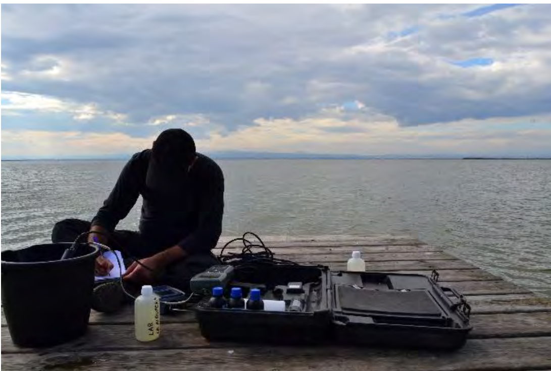
Foto 11: Toma de muestra de agua en L'Albufera de Valencia (embarcadero de la "Gola de Pujol") y medida de parámetros "in situ" (temperatura, pH y C.E.).
