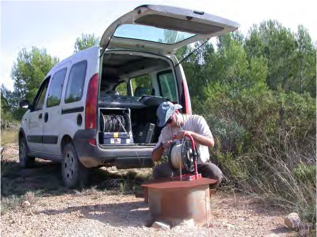
Foto 12: Medida del nivel piezométrico mediante sonda.
