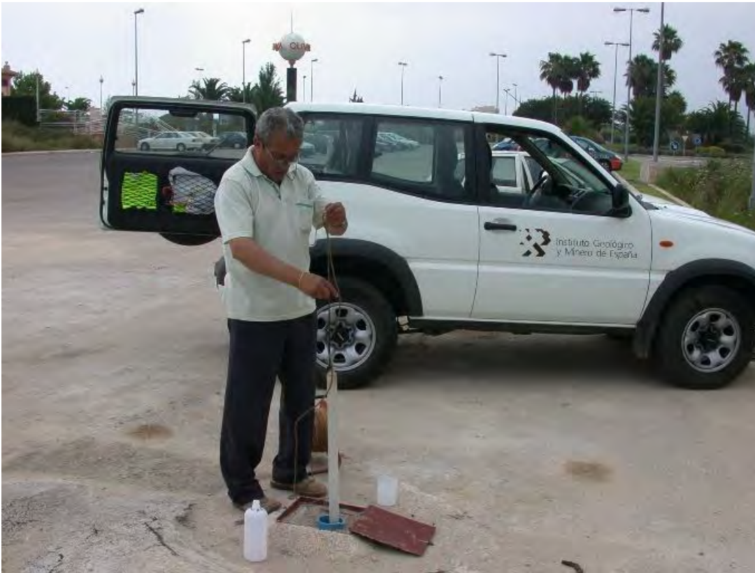
Foto 10: Toma de una muestra de agua subterránea en un piezómetro mediante tomamuestras.
