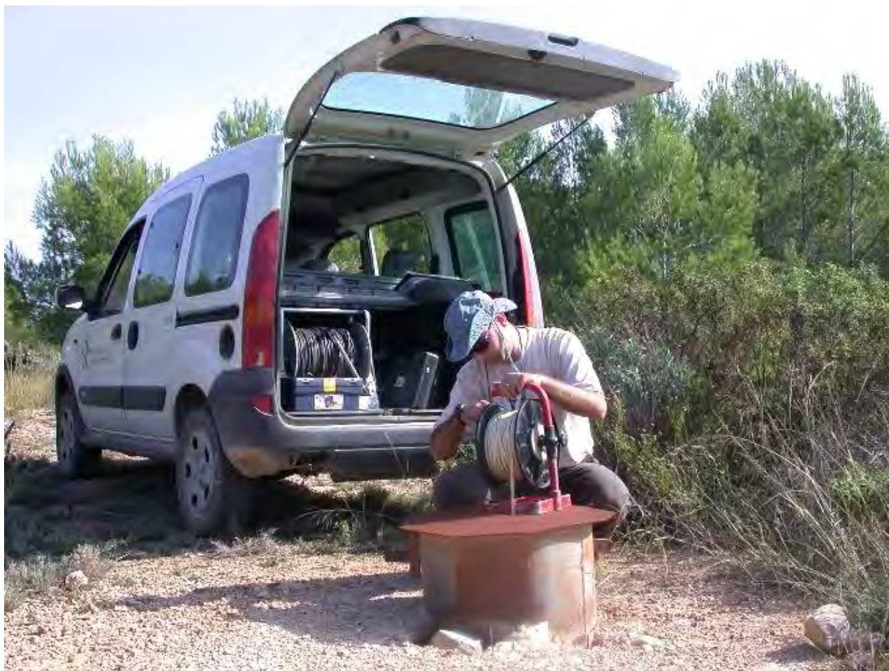
Foto 19: Medida del nivel piezométrico mediante sonda.
