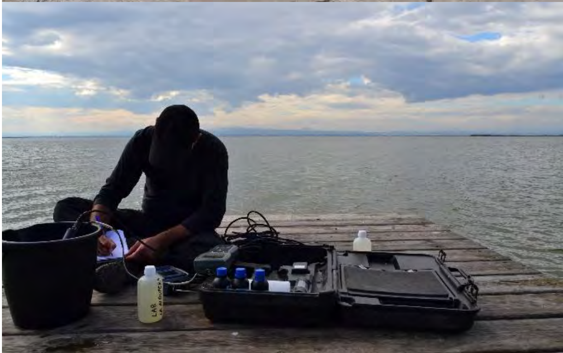
Foto 18 (imagen inferior): Toma de muestra de agua en L'Albufera de Valencia (embarcadero de la "Gola de Pujol") y medida de parámetros "in situ" (temperatura, pH y C.E.).
