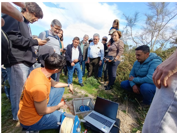
Medindo a profundidade do nivel de auga nun piezómetro de control.
