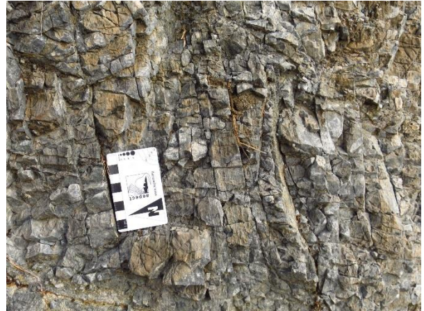
Foto 12.- Estratos de dolomías fracturadas que presentan laminaciones paralelas indicativo de medio sedimentario de baja energía (12/02/26).
