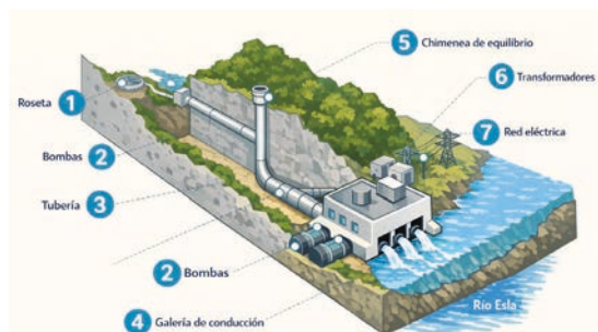
Figura 21. Esquema de bombeo del río Esla en Villalobar.
