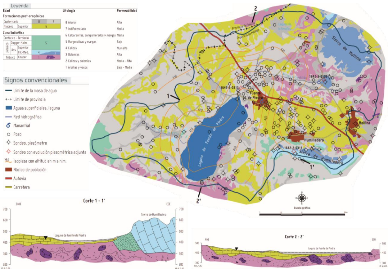
Figura 1. Esquema geológico – hidrogeológico de la cuenca endorreica de la laguna de Fuente de Piedra. Tomado de Heredia et al., (2007). Atlas Hidrogeológico de la Provincia de Málaga
