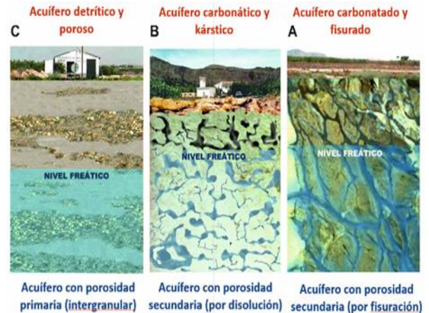
Figura 2: Tipos de porosidad en materiales acuíferos: por fisuras (A), por fracturas ensanchadas (B) e intergranular (C)
