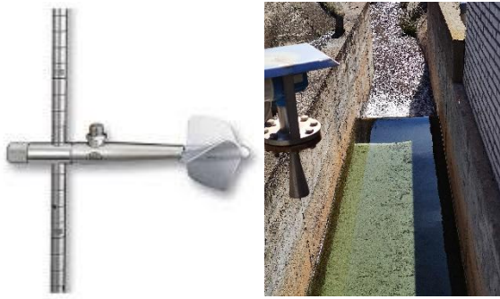
Figura 9. Detalle de la hélice de un micromolinete (izqda.) y dispositivo para la medida de la altura de la lámina de agua mediante ultrasonidos (dcha.)
