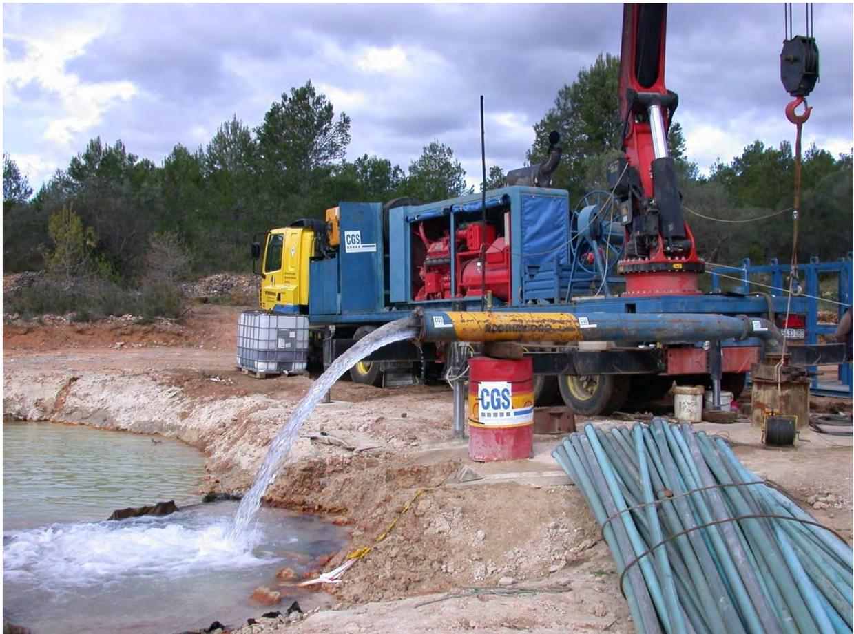
Foto 19: Ensayo de bombeo
