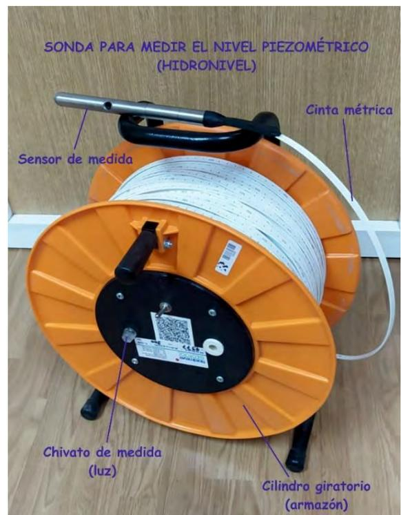
Foto 13: Sonda para medir el nivel piezométrico..
