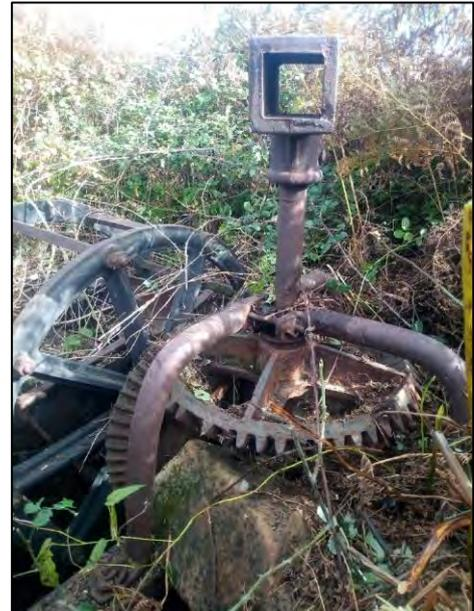
Foto 6. Mecanismo de extracción de agua artesanal de tipo cazoleta en La Valduerna (Autora: Almudena de la Losa)
