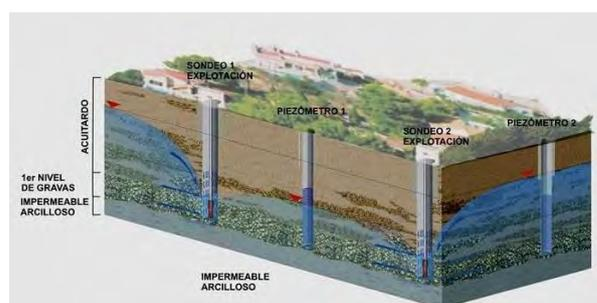
Figura 21. Diferentes niveles de captación en los sondeos en un acuífero detrítico y efecto del cono de depresión de la superficie freática por bombeo desde los niveles permeables. Fuente: IGME.
