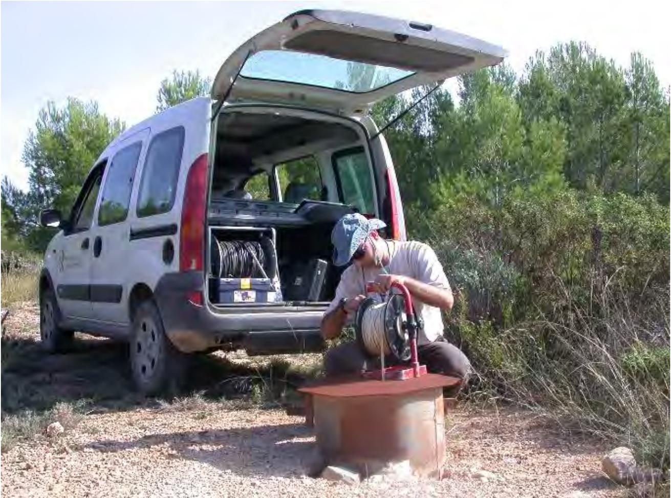
Foto 12: Medida del nivel piezométrico mediante sonda.
