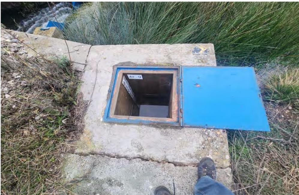
*FIGURA 18. Pozo de medida del nivel de la lámina de agua circulante mediante una escala limnimétrica.*
