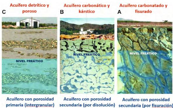
Figura 2: Tipos de porosidad en materiales acuíferos: por fisuras (A), por grietas o fracturas ensanchadas (B) e intergranular (C)
