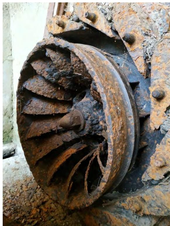
Figura 12. Sistema de turbinas del aserradero de Berto.
